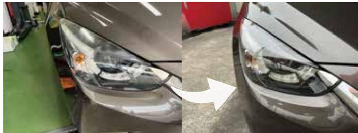
月間3台～5台施工実績があるヘッドライトクリーニングは、隠れた人気メニュー。紫外線の影響で黄ばんだり白っぽく変色してしまったヘッドライトは、通常の洗車では落とすことは出来ず、サンドペーパーでダメージを受けている箇所を磨き、ポリッシャーを使ってレンズ表面を仕上げることで透明感のあるヘッドライトに戻すことが出来ます。
